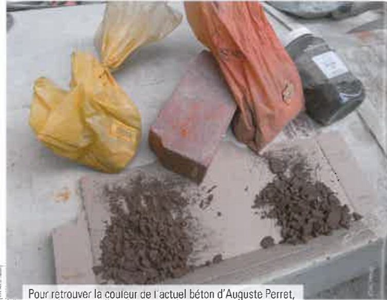
Pour retrouver la couleur de l'actuel béton d'Auguste Perret, l'entreprise Pierre Noël a procédé de nombreux essais, dont certains avec des pigments réalisés par des artistes.
